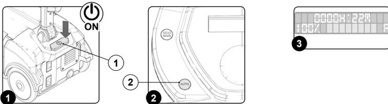
Falls nur geschrubbt werden soll, ohne Austritt von Reinigungslösung, halten Sie einfach ein paar Sekunden lang die Taste (3) am Instrumentenbrett (**Abb. 4**) gedrückt, auf diese Weise schaltet sich die entsprechende Pumpe ab und die Abgabe der Reinigungslösung auf die Bürste wird deaktiviert. Wird die Abgabe der Reinigungslösung unterbrochen, erscheint am Display des Instrumentenbretts anstelle
