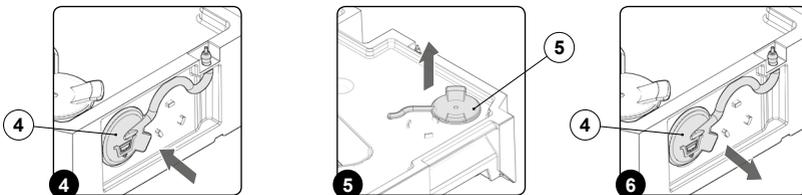
6. Bringen Sie den im hinteren Teil des Reinigungslösungstank vorhandenen Ablaufverschluss (4) zum Ablassen der Reinigungslösung an seinem Sitz (**Abb. 7**) an.
