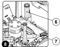
12. Setzen Sie den Schmutzwassertank vorsichtig auf den Reinigungslösungstank, achten Sie dabei darauf den Saugschlauch (6) am Eingang des Saugmotors und den Saugschlauch des Saugfußgestells (7) nicht zu beschädigen. Verwenden Sie zum Positionieren des Tanks die am Reinigungslösungstank vorhandenen Griffe (3) (Abb. 9 und Abb. 10).
