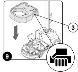
8. Setzen Sie den Reinigungslösungstank in das Gerät ein, achten Sie dabei darauf den Saugschlauch (6) am Eingang des Saugmotors und den Saugschlauch des Saugfußgestells (7) nicht zu beschädigen. Verwenden Sie zum Positionieren des Tanks die am Reinigungslösungstank vorhandenen Griffe (9) (**Abb. 9 und Abb. 10**).
