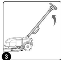
4. Sobald sich der Lenker in der senkrechten Stellung befindet, den Feststellhebel (2) loslassen, um den Lenker zu arretieren.
