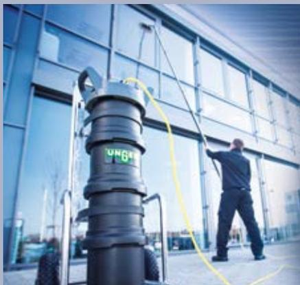
Das Prinzip des **nLite®** Systems besteht darin, nur mit reinem Wasser und einer Bürste zu reinigen. Das ist am effizientesten sowie umweltfreundlich. Auf diese Weise reinigen Sie in bis zu 20 m Höhe sicher und schnell vom Boden aus.
